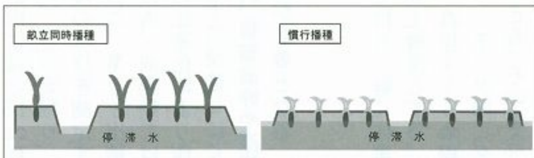
図3 畝立同時播種と慣行播種(模式図)
