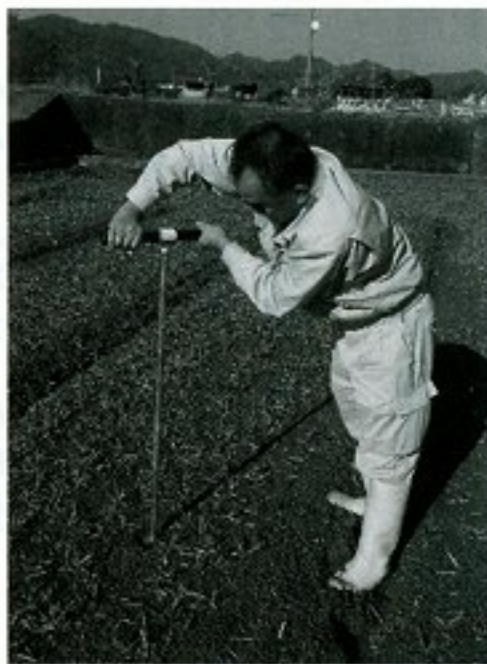
写真1 穴掘りオーガと地下水位確認用の穴
